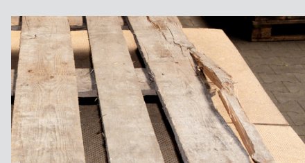
Planchette cassée entièrement ou partiellement
