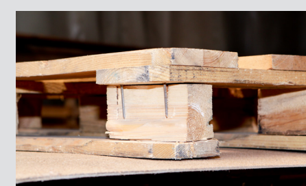
Extrémités des pointes ou plus de 2 tiges de pointes visibles par palette.
